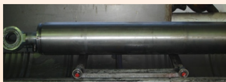
Гидроцилиндр подъема в сборе ПРМ5-04.11
