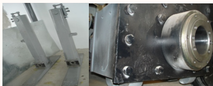
Подъемно-рихтовочный механизм ПРМ5-04
