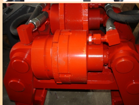
2. Цилиндр сжима шпалозахвата 84.021-11.01.200
