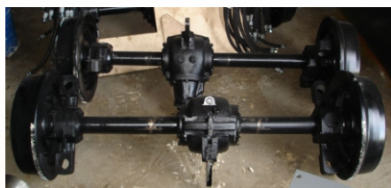
чертежный номер 1.Пара колесная приводная задняя ПРМ5-05
